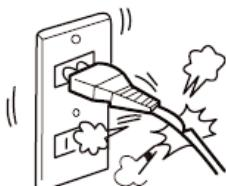
Запрещается подключать прибор к электросети, если сетевой шнур или вилка повреждены. В таких случаях следует обратиться в сервисный центр производителя за заменой шнура.
