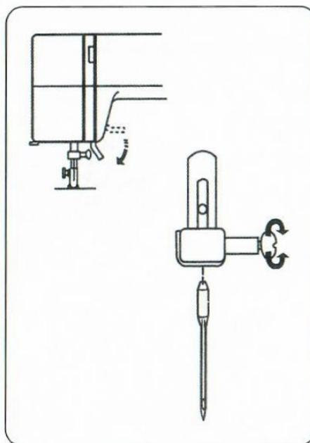
Освободить зажимный винт иглы, поворачивая его против часовой стрелки.
