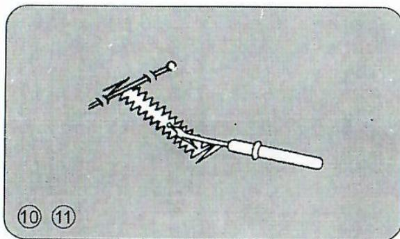
10 Отрезать обе нити - иглы и бобины, оставляя концы длиной ок. 10 см. Тянуть нить иглы на обратную сторону ткани, вытягивая нить бобины. Затем связать нити.
