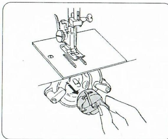
Поднять иглу, поворачивая колесо баланса к себе. Извлечь барабанчик бобины, удерживая за защелку.
