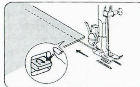
Для закрепления концов полос, нажать клавишу обратного прокладывания шва и сделать несколько стежков в обратном направлении. Поднять прижимную лапку и убрать ткань, убирая нити назад.
