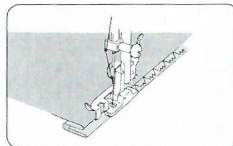
Поднять прижимную лапку и поместить ткань под лапку так, чтобы мягкий сгиб опирался против стенки направляющей подогнутого среза. Опустить лапку, затем прошить медленно для лучшего контроля, чтобы стежки "зиг-заг" попадали на припуск подогнутого среза и прошивали мягкий слой. При шитье следить, чтобы мягкий сгиб проходил вдоль стенки направляющей подогнутого среза.
