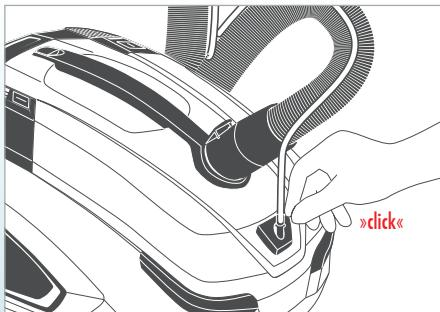
Присоединить распылительную трубку к прибору, используя быстроразъемный соединитель.
