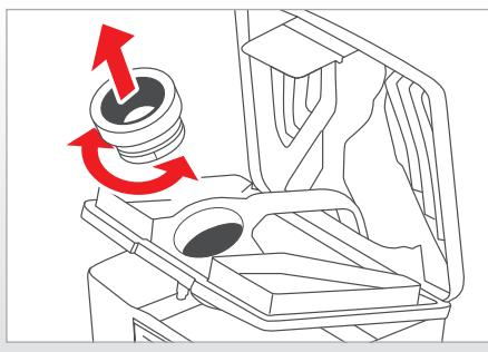
При сильном загрязнении так называемый инжектор можно снять в целях очистки, вращая уплотнение патрубка.
