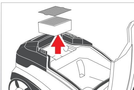
Замена специального гигиенического фильтра и специального гигиенического фильтра предварительной очистки
