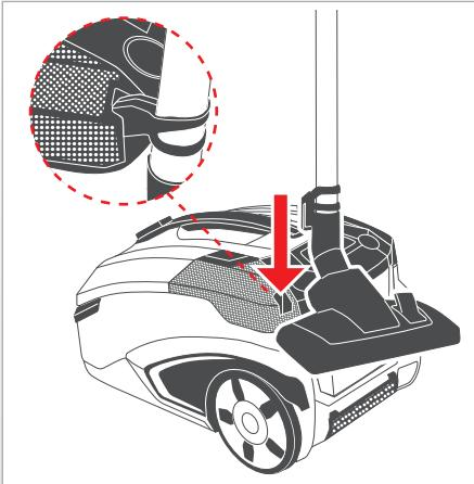
Для крепления всасывающей трубки на приборе использовать парковочное устройство, расположенное на телескопической трубе.
