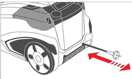
Вынуть вилку из розетки после окончания использования и перед хранением. Слегка потянуть сетевой шнур в сторону от прибора и отпустить его. После этого кабель сматывается автоматически.
