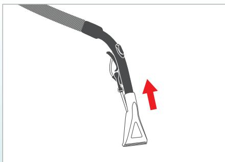
При использовании насадки для влажной очистки мягкой мебели\* присоединить ее непосредственно к рукоятке всасывающего шланга.
