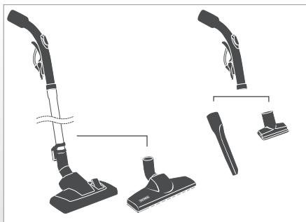
**Присоединить телескопическую трубу и/или насадку, выбранную для требуемой уборки, к рукоятке всасывающего шланга.**
