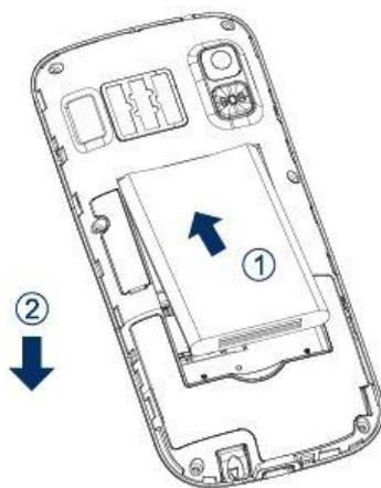
Закрыть крышкой аккумуляторный отсек и нажать на неё до полной фиксации.
