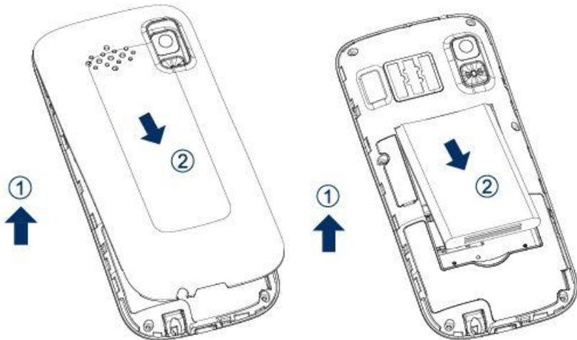
Установку SIM-карт необходимо производить в предназначенные для них слоты так, чтобы угловой срез SIM-карт совпадал с инструкцией по установке SIM на корпусе телефона.
