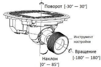
Рисунок 1-25 Настройка угла наблюдения камеры
