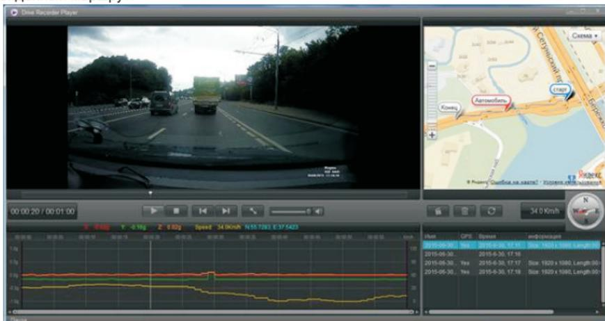
6. Внутри установлен 3G-Sensor датчик гравитационного изменения, как на рис. ниже, когда возникает мгновенное изменение силы тяжести любого направления осей X, Y, Z , трехмерный рисунок изменения выходит в нижеследующем графике, если сила удара сравнительно большая, то автоматически блокирует данный отрывок, не заменяется другими снимками; (данную чувствительность можно настроить в меню)
