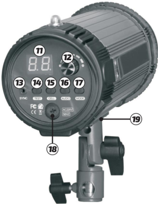
11-двуразрядный цифровой индикатор мощности; 12-валкодер регулировки мощности; 13-синхроразъем; 14-кнопка «TEST» с индикатором готовности; 15-кнопка «SELL» выбора способа запуска с индикацией; 16-кнопка «AUDIO» выключения звука с индикацией; 17-кнопка «MODE» режима работы лампы пилотного света; 18-крышка предохранителя; 19-разъем сетевого кабеля
