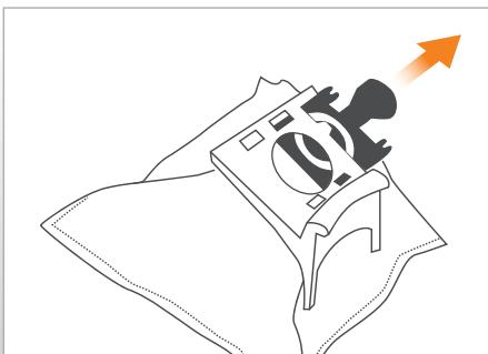
Извлечь пылесборник из держателя. Для этого потянуть пылесборник за цветную ручку. При этом преодолеть сопротивление стопора на держателе, слегка прижав вверх пластиковую поверхность пылесборника.
