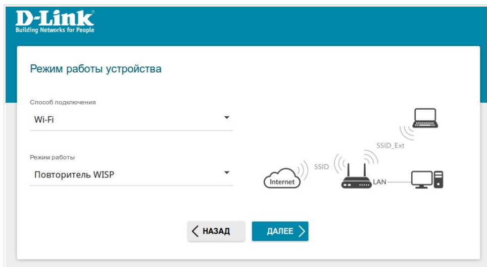
Рисунок 25. Выбор режима работы устройства. Режим Повторитель WISP .
