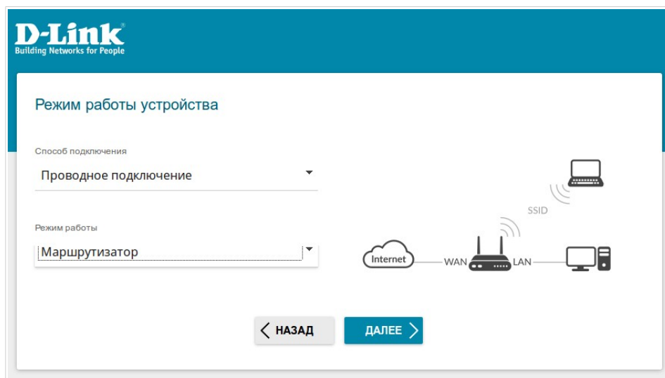
Рисунок 23. Выбор режима работы устройства. Режим Маршрутизатор .
