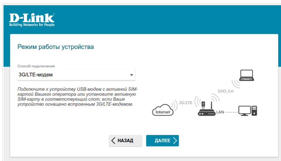
Рисунок 24. Выбор режима работы устройства. Режим 3G/LTE-модем .
